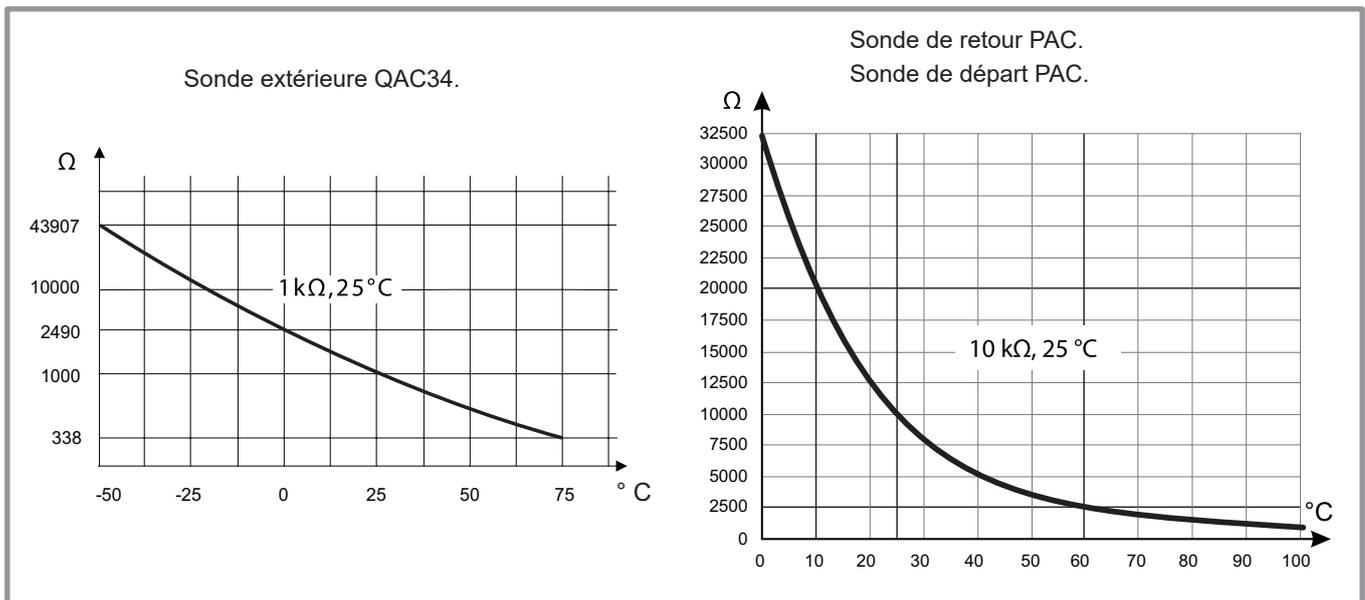
figure 5 - Valeur ohmique des sondes (Module hydraulique)
