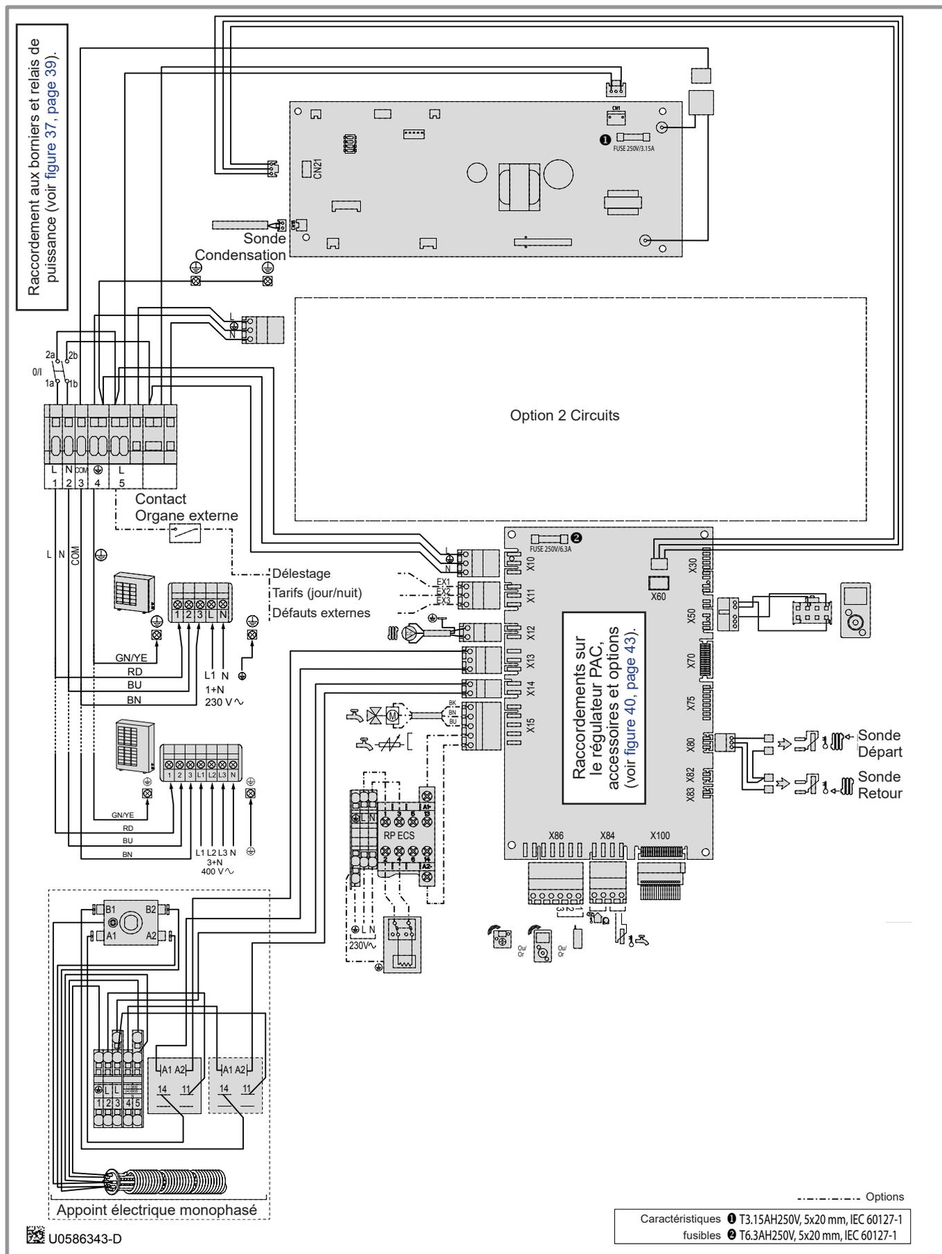
figure 49 - Câblage électrique module hydraulique Alféa Excellia monophasée (hors raccordements installateur)
