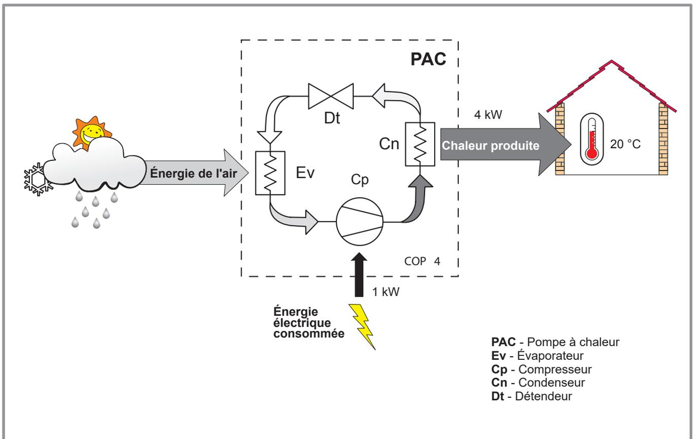
figure 11 - Principe de fonctionnement d'une pompe à chaleur
