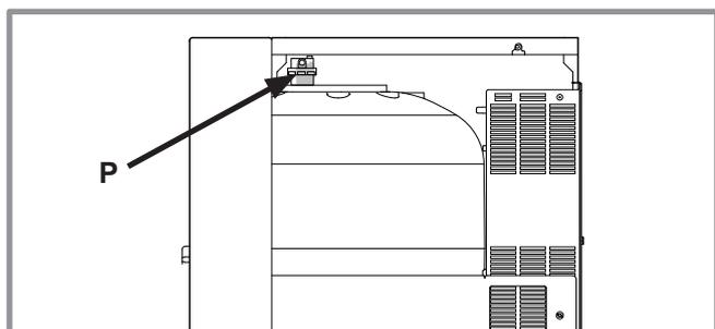
figure 25 - Purgeur automatique du module hydraulique
