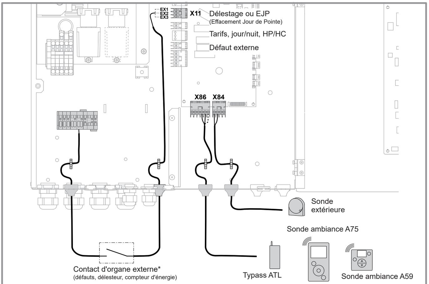
figure 41 - Passage des câbles des sondes
