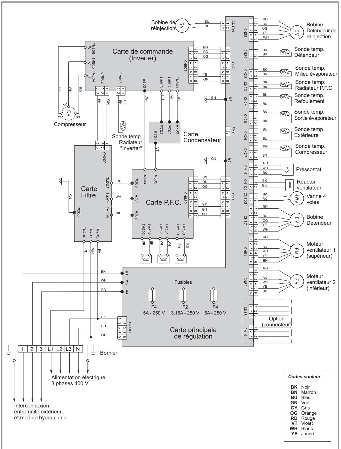
figure 48 - Câblage électrique unité extérieure modèle Alféa Excellia A.I. triphasée
