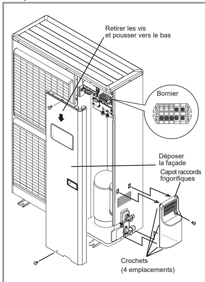
figure 30 - Accès au bornier de l'unité extérieure monophasée
