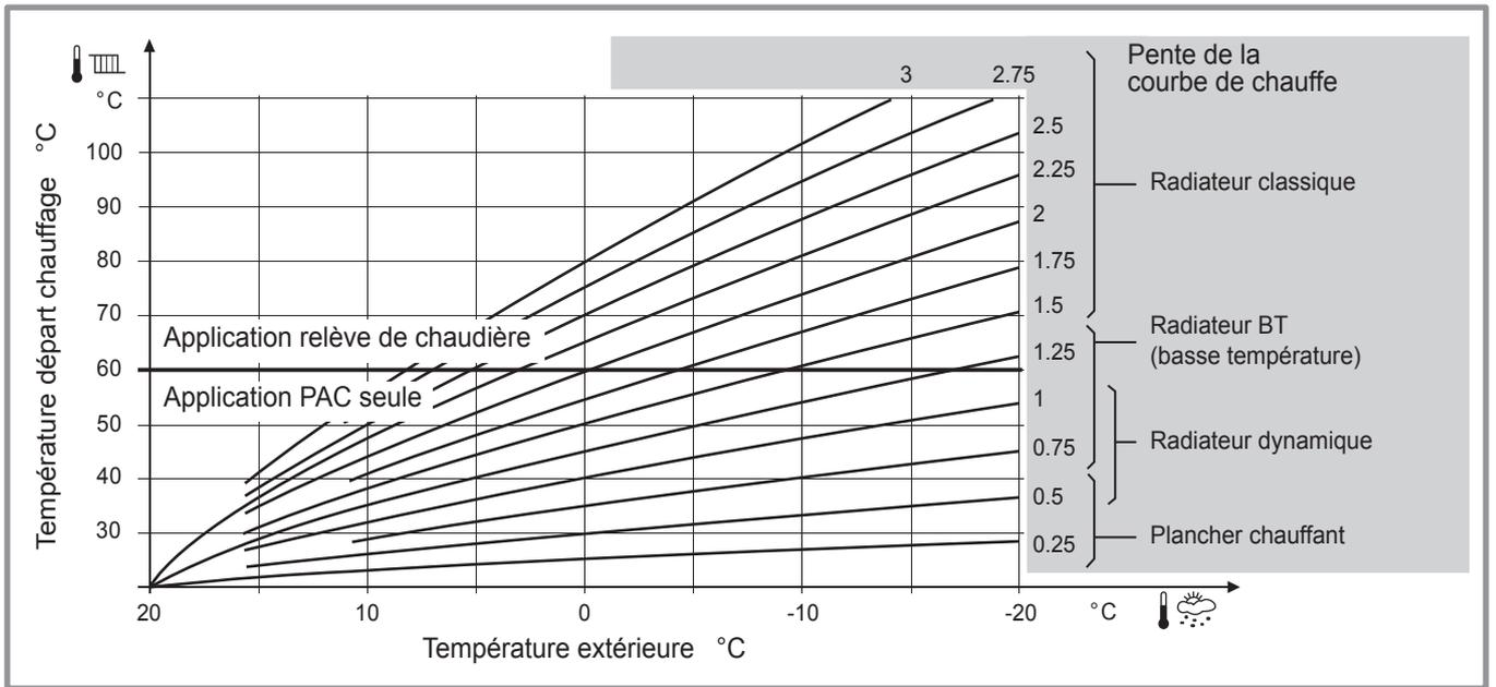
figure 44 - Pente de la courbe de chauffe
