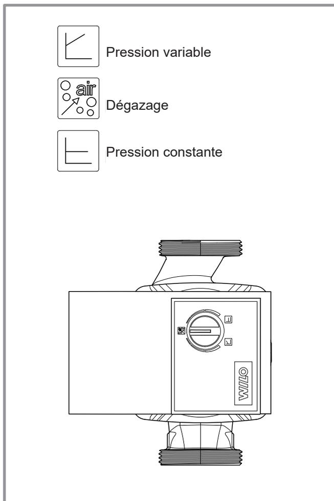
figure 28 - Bouton de réglage du circulateur
