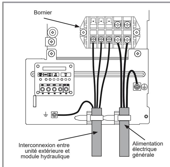
figure 31 - Connexions au bornier de l'unité extérieure monophasée
