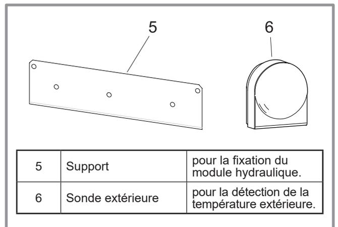
figure 4 - Accessoires fournis avec le module hydraulique
