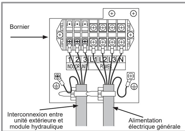
figure 34 - Connexions au bornier de l'unité extérieure triphasée
