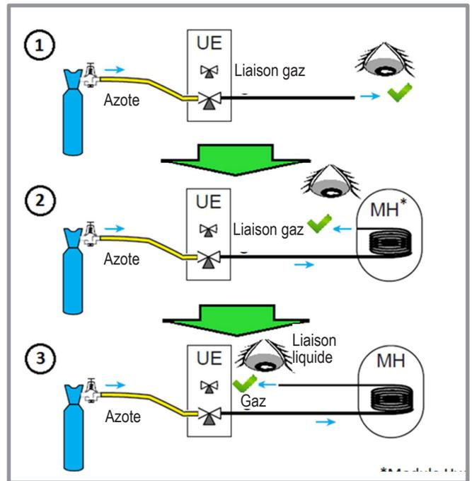
figure 21 - Vérification des liaisons frigorifiques
