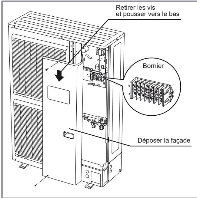
figure 33 - Accès au bornier de l'unité extérieure triphasée
