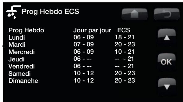
Le lundi matin à 6 h, le système commence à produire plus d'eau chaude jusqu'à 9 h lorsque la température revient à la normale. Il y a une nouvelle augmentation entre 18 h et 21 h.
