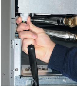
1. Débranchez le connecteur d'alimentation du module frigorifique et les tuyaux.
