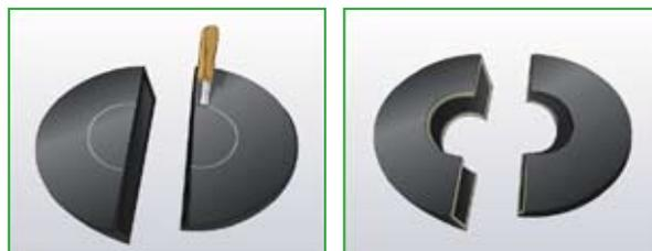
En utilisant un couteau à lame courte, découper une réservation pour le diamètre de la tuyauterie isolée.
