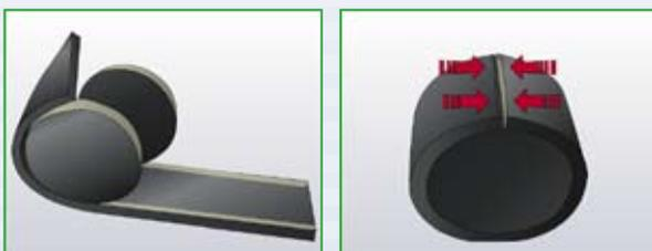
Enrouler la bande du corps autour des disques de fermeture sans tirer sur l'isolant durant l'opération. Contrôler partout l'alignement.
