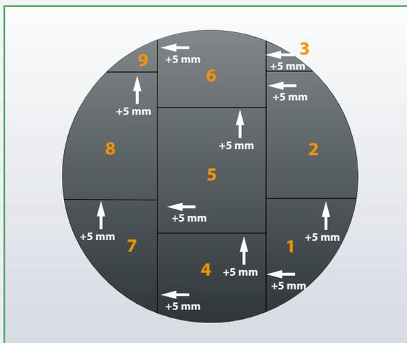
Pour déterminer l'arrête circulaire nécessaire à la découpe des panneaux constituant l'isolation des bords du dôme, marquer à la craie blanche l'arrête circulaire de l'isolant déjà en place.
