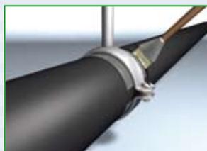
Poser les manchons d'Armaflex de part et d'autre du support de fixation Armafix. Coller les surfaces jointives entre l'Armaflex et l'extrémité du manchon en utilisant la colle Armaflex.
