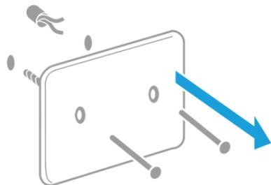
Attention: Ce thermostat ne nécessite pas de câblage. Isolez les conducteurs et repoussez dans le mur.
