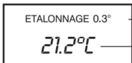
Valeur de décalage (différence entre la température mesurée et la température affichée) réglable de -5,0 à + 5,0 °C
