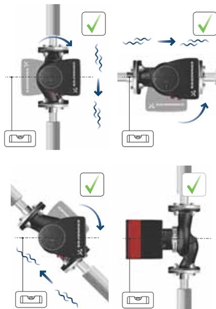
Abb. 11 Pumpe mit Schaltkasten in horizontaler Position
