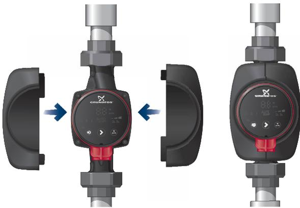
Abb. 8 Isolieren des Pumpengehäuses
