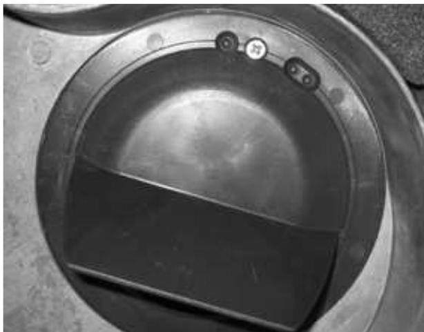
Die Position der Einströmdüse ist werkseitig voreingestellt, kann aber den unterschiedlichen Anlagenbedingungen, Seehöhe und Leistungen angepaßt werden.
