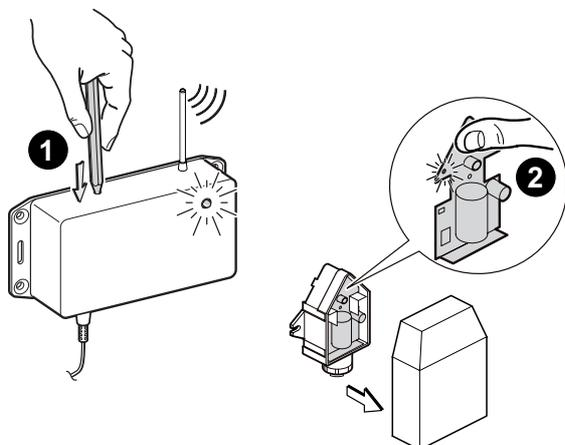
Chaque sonde extérieure intègre d'usine un numéro d'identification unique qui permet au module chaudière radio de la reconnaître. Ce numéro d'identification est transmis au module chaudière radio par la séquence d'appairage décrite ci-après.
