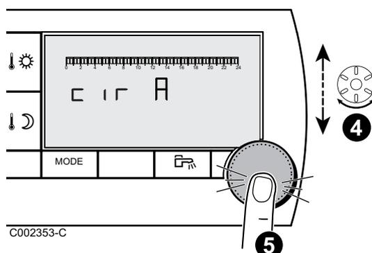
**4** Tourner le bouton de réglage pour sélectionner le circuit souhaité.
