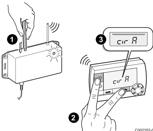
**1** Appuyer sur le bouton poussoir du module chaudière radio à l'aide d'une pointe de stylo. Le voyant du module chaudière radio s'allume.
