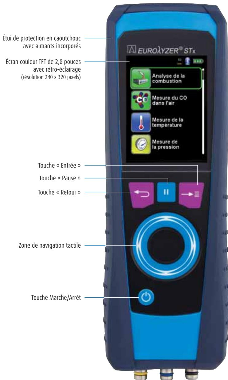
fig. 5 : Face de l'instrument
