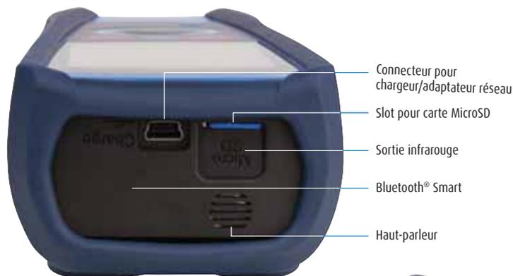
fig. 6 : Dessus de l'instrument
