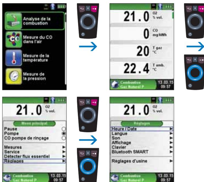
fig. 50 : Accès à la fonction « Réglages » via le Menu principal (ex. : Combustion)
