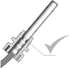
Die mitgelieferte Kunststoffüberwurfmutter wird zum Ende der Tauchhülse geschoben, bis es Klick macht, wenn die Überwurfmutter die erste Rändelung erreicht hat.
