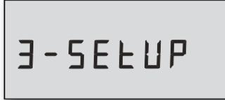
Zum Aktivieren der Setup-Schleife drücken und halten Sie bitte ( ca. 9 Sekunden) die Fronttaste bis im Display "SETUP" angezeigt wird.
