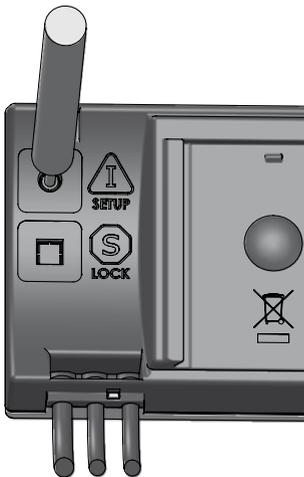
Der Transportmodus wird aufgehoben, wenn der Zähler die erste Volumensummierung registriert hat, entweder 0,01 m<sup>3</sup> (10 L) oder 0,001 m<sup>3</sup> (1 L) – abhängig von der gewählten Auflösung.
