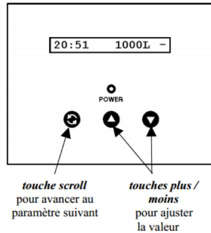
Le programmateur électronique utilise une plaquette électronique, équipée d'un micro-processeur et NOVRAM®. Toute la programmation est faite par moyen du clavier tactile à 3 touches avec écran LCD.
