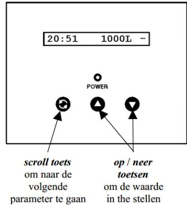
De elektronische timer gebruikt een Printed Circuit Board (PCB) uitgerust met een microprocessor en NOVRAM®. De programmatie gebeurt via de 3 toetsen op het bedieningspaneel met LCD-display.
