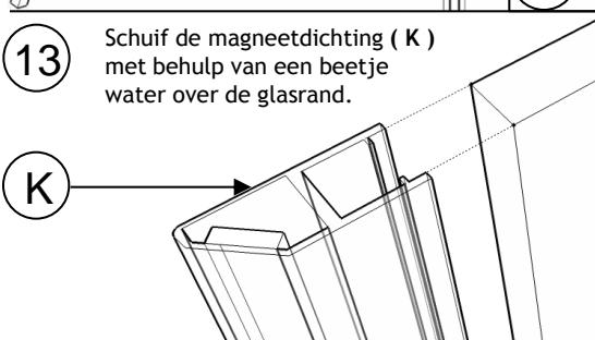
Schuif de magneetdichting ( K ) met behulp van een beetje water over de glasrand.
