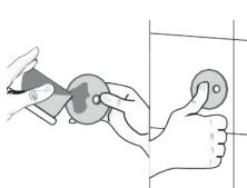
NL Open het zakje op de aangeduidte plaats met een schaar en bevestig een kleine hoeveelheid lijm op de reeds gepoetste montageplaat en ondergrond. Duw de montageplaat stevig op de muur en laat deze 4 uur drogen.
