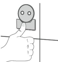
! NL Indien die Montageplatte nach unten dreigt zu fallen: Verwijder die weiße beschermfolie von der beigelegte Kartonnen steun. Kleef dit karton unter die Montageplatte. Na de 4 uur droogtijd, verwijder de steun vooraleer het accessoire te monteren.
