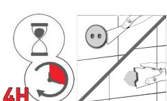
DE Montageplatte anschließend fest an die zu beklebende Fläche andrücken. Nach Ablauf der vierstündigen Aushärtezeit können Sie eventuelle Kleberückstände vorsichtig (z.B. mit einem Teppichmesser) entfernen, bevor Sie Ihr Produkt an der Montageplatte befestigen.
