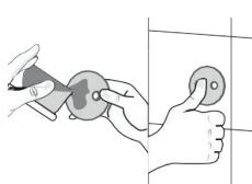
NL Open het zakje op de aangeduidte plaats met een schaar en bevestig een kleine hoeveelheid lijm op de reeds gepoetste montageplaat en ondergrond. Duw de montageplaat stevig op de muur en laat deze 4 uur drogen.
