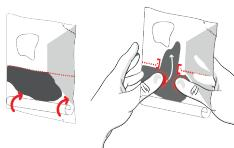
NL Plooï de onderrand van het onderste compartiment en duw de lijm met beide duimen naar de middenlijn van het zakje zodat de naad barst.
