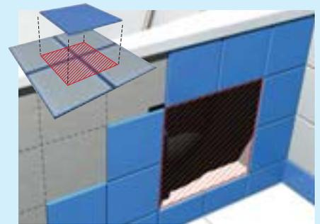
Procéder à la pose des carreaux et à la confection de la trappe (partie carrelage) en utilisant un carreau supplémentaire collé au dos.
