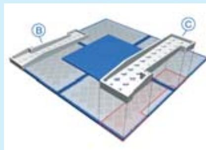
Positionner suivant les pattes de guidage les pièces B et C sur l'arrière de la trappe dans les angles hauts.
