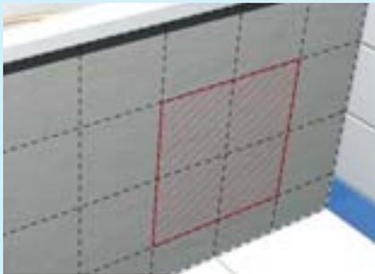
Positionner l'emplacement de la trappe par rapport à la pose des carreaux de faïence.
