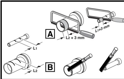
Verifieer de afmetingen van het inbouwsysteem met deze van de hangwc volgens de tekening. Stel bij waar nodig. Meet de aan\*- & afvoerbuis\* af en zaag af op de gewenste lengte + 3 mm. Vijl de buizen af in een hoek van 45°. Doe glijmiddel\* op de buizen en bevestig ze in de muur. Monteer de draadstangen.
