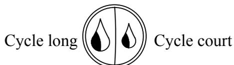
Par défaut l'appareil se remplit pendant 11 secondes en cycle court et 17 secondes en cycle long.
