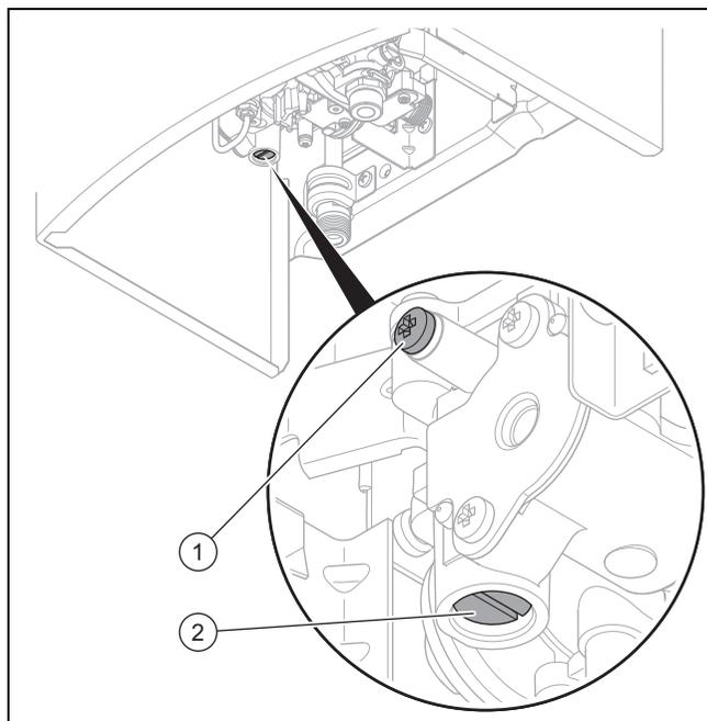
1. Tournez le sélecteur de température jusqu'à la butée dans le sens des aiguilles d'une montre pour réduire la quantité d'eau et régler la température maximale de l'eau.
