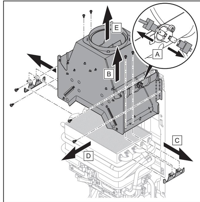
1. Débranchez les câbles du capteur des gaz de combustion.
