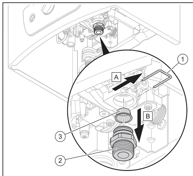
1. Enlevez du raccord d'eau froide la conduite du raccordement du filtre d'eau froide (2).
