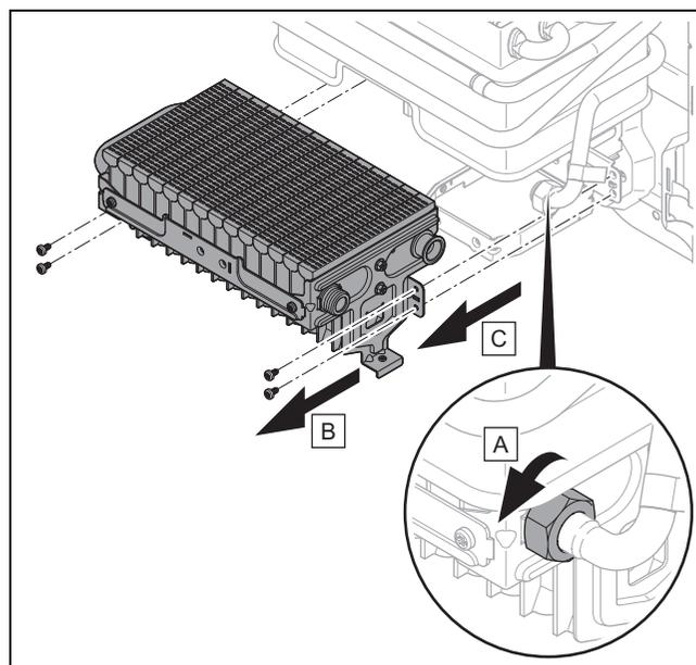
9. Dévissez l'écrou-raccord du raccord d'eau de l'échangeur thermique du brûleur.
