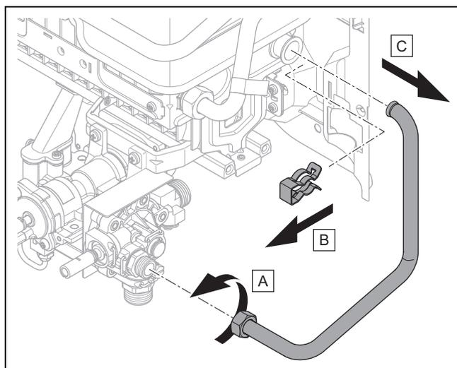
4. Dévissez l'écrou-raccord de la vanne d'eau. Retirez l'attache du raccord d'eau froide du brûleur.
