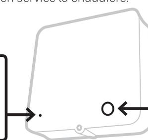
Appuyez sur le bouton **une fois** pour vous assurer que la chaudière est mise sous tension - La **LED du bouton** doit s'allumer, de façon permanente, et être de couleur **VERTE**. Appuyez une nouvelle fois pour couper l'alimentation de la chaudière - La **LED du bouton** doit s'éteindre
