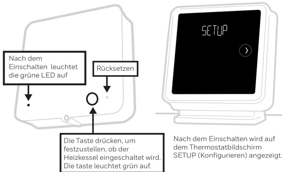
Um erneut zu binden, die Empfänger zurücksetzen, und die Taste für 3 Sekunden drücken. Die LED auf dem Empfänger blinkt gelb, um den Bindung Modus anzuzeigen. Auf dem Thermostat für mindestens 5 Sekunden drücken, um in das erweiterte Menü zu gelangen. Navigieren Sie zu Binden, löschen Sie die aktuelle Bindung dann binden Sie das Gerät erneut.
