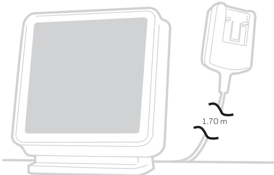
Den richtigen Stecker auswählen. Das Thermostat auf einer flachen horizontalen Oberfläche anbringen und anschließen.
