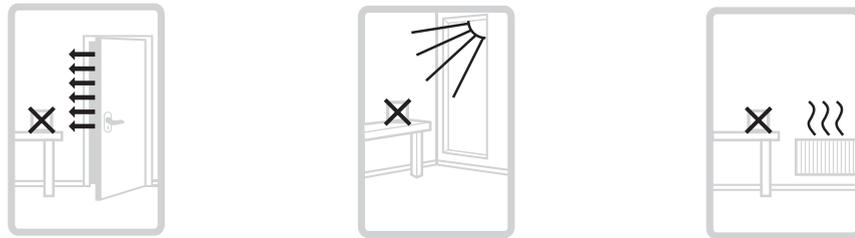
Das T6R Thermostat darf nicht an einer Stelle mit Zugluft oder direkter Sonneneinstrahlung bzw. neben Wärmequellen installiert werden.
