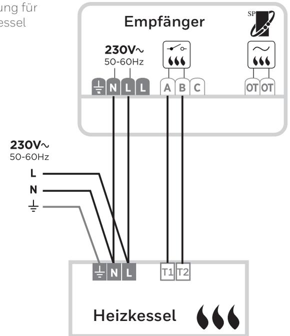
C) Verdrahtung für OpenTherm-Heizkessel
