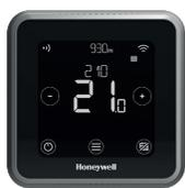
Compatible avec les appareils marche/arrêt 24-230 V et OpenTherm® comme les chaudières à gaz, les chaudières combinées et les thermopompes. Fonctionne aussi avec les vannes de zone, mais pas avec le chauffage électrique (240 V).
