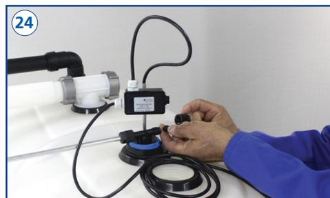
Letzte Entnahmegrundeinheit mit Verschlußstopfen und Überwurfmutter verschliessen.
