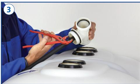
Schaumrohr bis zum oberen Ende auf die Tülle des T-Stücks mit Düse schieben, Federbandschelle nachsetzen und am Tank montieren.
