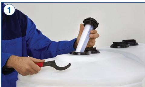
Adapter lösen, Dokumentenköcher demontieren, Papiere entnehmen und ausgefüllt dem Anlagenbesitzer übergeben.
