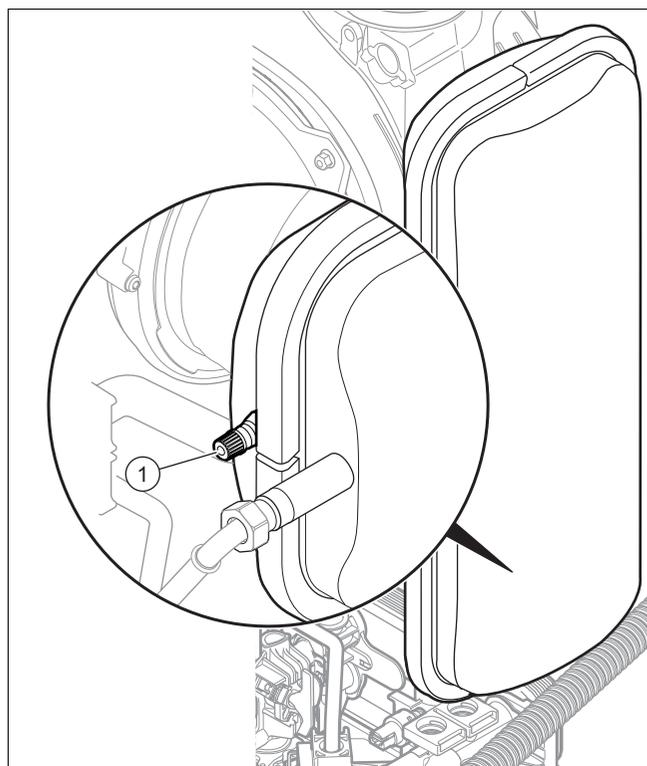
1. Mesurez la pression du vase d'expansion au niveau de la soupape du vase (1).
