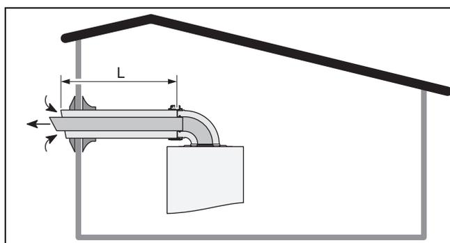
Les orifices d'un terminal pour conduits séparés doivent déboucher dans un carré de 50cm de côté.
