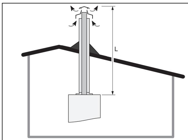
Les orifices d'un terminal pour conduits séparés doivent déboucher dans un carré de 50cm de côté.
