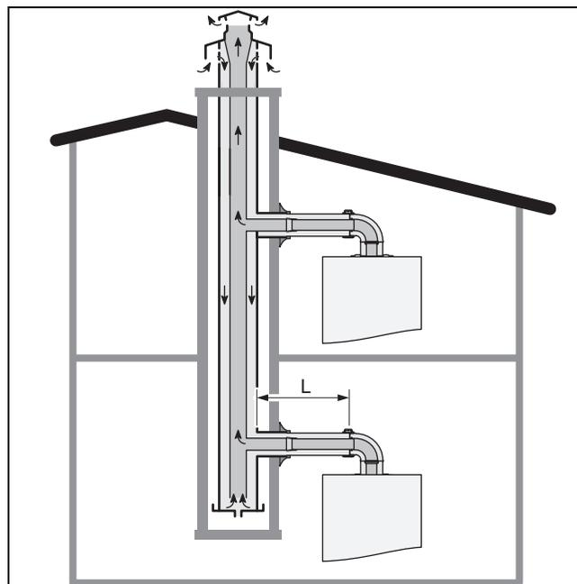
Les liaisons au conduit seront réalisées à l'aide de l'accessoire spécialement développé par le fabricant du produit.
