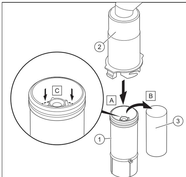
1. Déclipsez la partie inférieure du siphon (1) de la partie supérieure du siphon (2).
