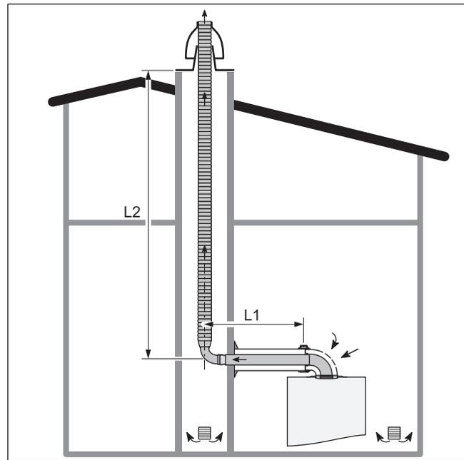
Cette configuration permet de réutiliser un ancien conduit de fumée ou de ventilation pour l'implantation d'un conduit de chaudière étanche.
