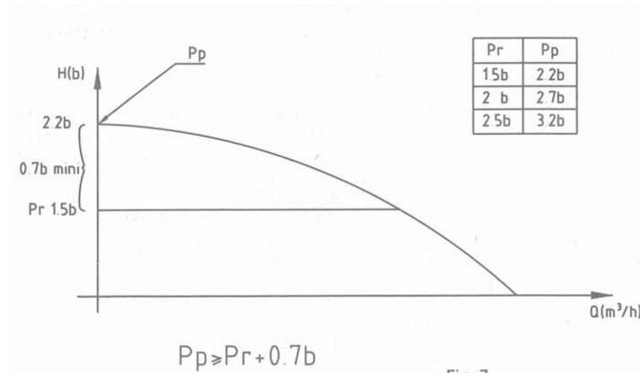
Abb. 7: Nullförderhöhe und Einschaltdruck
