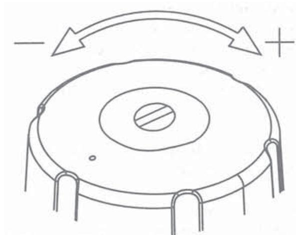
**Abb. 5:** Einstellschraube zur Einstellung des Einschaltdrucks
