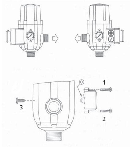
Abb. 4: Manometer drehen
