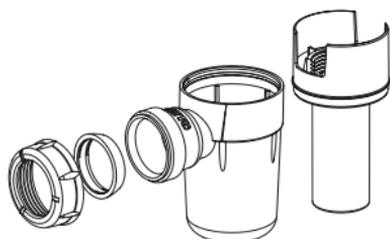
Attention : le déflecteur doit être installé selon le dessin ci-dessous de façon à respecter la cote de 20 mm minimum.
