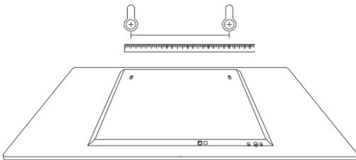
1. Mesurez la distance entre les trous de montage de centre à centre
