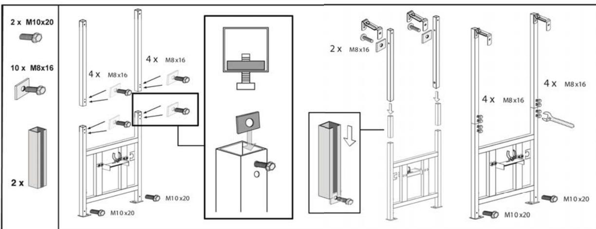
1. Plaats de metalen plaatjes met de bout in het bovenste en onderste frame in de voorziene plaatsen. De metalen plaatjes moeten aan de binnenkant van het frame geschoven worden en schroef de bout lichtjes vast. Schuif de tussenstukken over de metalen plaatjes van het onderste frame en daarna het bovenste frame. Schroef de muurbevestigingen, het frame en de verstelbare poten vast.
