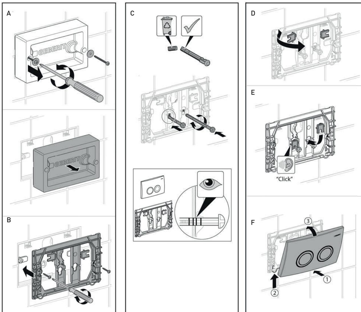
9. Monteer het bedieningspaneel als de wand volledig is afgewerkt. Schroef de beschermdoos los (A). Schroef de onderplaat (B) van het bedieningspaneel vast. Indien nodig kort de bedieningsstangen in volgens de dikte van uw wand, dit door ze bij het groefje af te kraken. Monteer de bedieningsstangen (C). Breek voorzichtig de hulpstukjes af (D) en klik deze vast op de bedieningsstangen (E). Bevestig daarna het bedieningspaneel (F).
