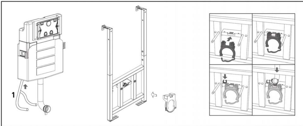
2. Monteer de wachtbuis (1) onderaan het reservoir. De wachtbuis is bedoeld voor installatie van een hygiënische sproeier (niet inbegrepen). Bevestig de houder voor de afvoerbocht door de twee onderste haken van de houder onder het ijzeren plaatje te schuiven en daarna de bovenkant er op te klikken. Klik de beugel voor de wachtbuis vast op het frame (zie tekening).
