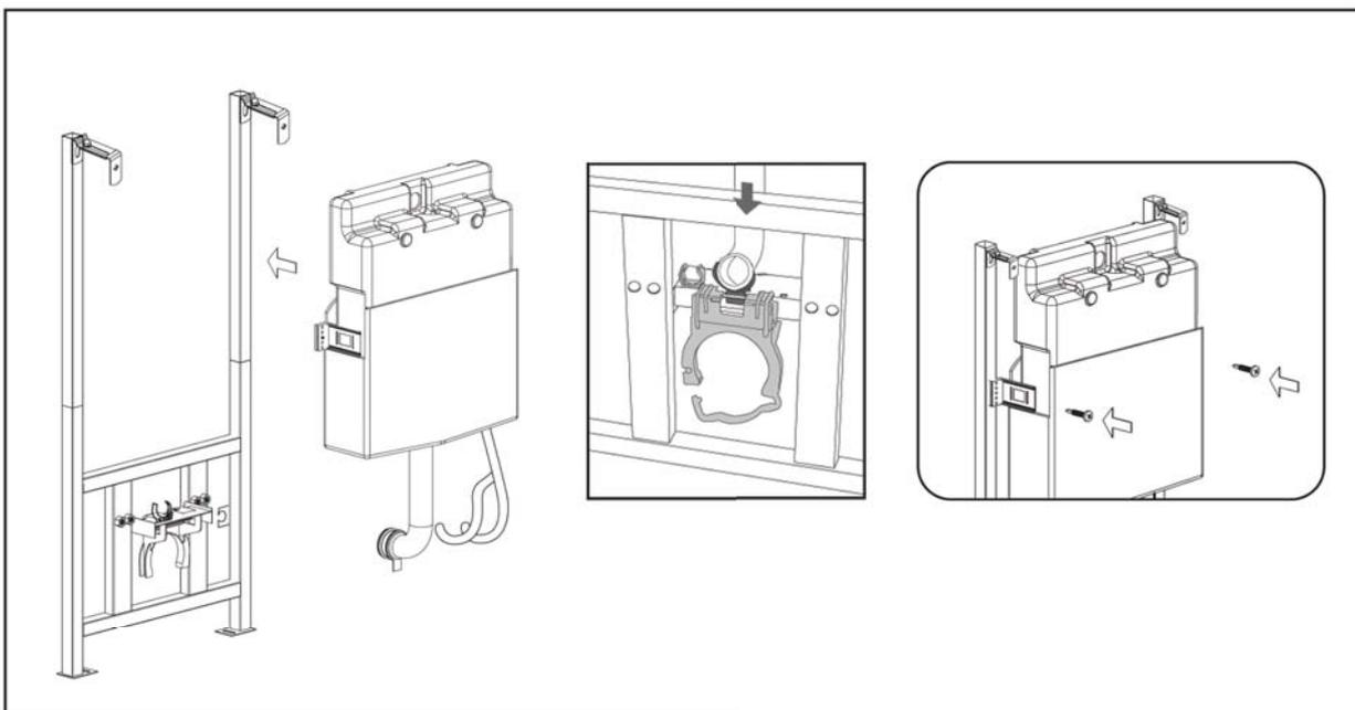
3. Zet de spoelbocht vast aan het kader door de beugel in het daarvoor voorziene gleufje te plaatsen. Monteer ook de wachtbuizen op de voorziene gaten. Plaats daarna het reservoir in het frame en schroef deze vast.
