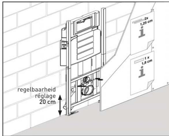
5. Plaats het inbouwmechanisme op de gewenste plaats. Gebruik de regelbare poten om het inbouwmechanisme op de gewenste hoogte te zetten. Hou rekening met de tegelvloer bij het instellen van de hoogte. Bevestig het inbouwmechanisme tegen de muur. Vooraleer het inbouwmechanisme in te bouwen, meet u eerst af waar de openingen voor de bedieningsplaat, spoeling en afvoer moeten komen.
