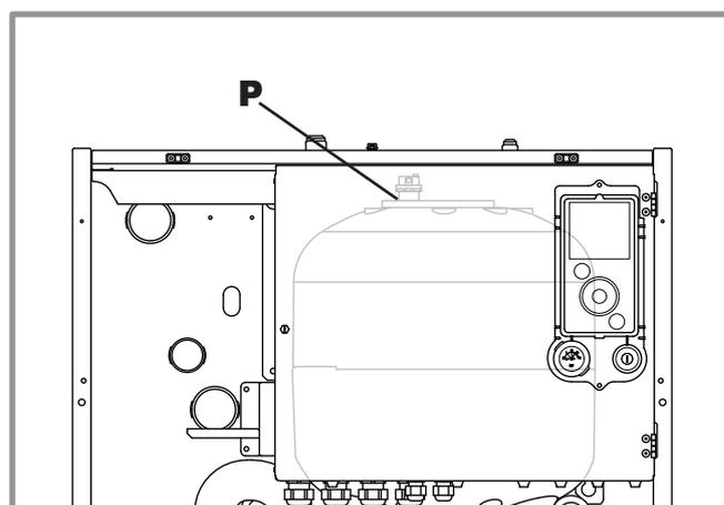
Abbildung 4 - Automatisches Ablassventil
