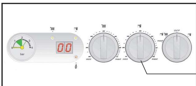
Pour régler la température de l'eau chaude sanitaire, tournez le bouton de réglage de la température d'eau chaude sanitaire :
