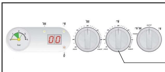
Pour régler la température de l'eau chaude sanitaire, tournez le bouton de réglage de la température d'eau chaude sanitaire :
