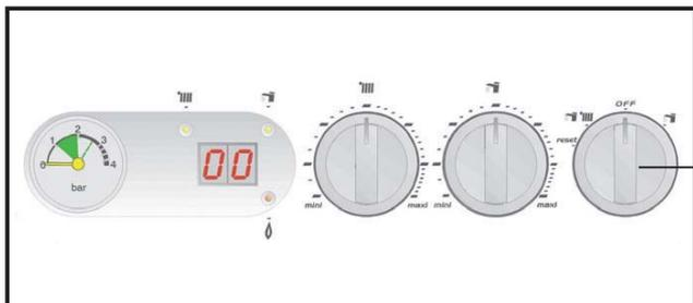
Tournez le bouton de mode de fonctionnement vers la gauche pour le placer sur la position **RESET**.
