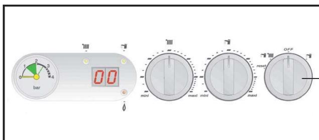
Tournez le bouton de mode de fonctionnement vers la droite pour le placer sur le mode de fonctionnement été
