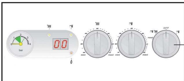
Tournez le bouton de mode de fonctionnement vers la gauche pour le placer sur le mode de fonctionnement hiver
