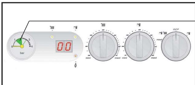
L'aiguille de pression du circuit de chauffage est dans la zone verte entre 1 et 2 bar. Si la pression du circuit de chauffage est inférieure à 1 bar, rajoutez de l'eau dans le circuit jusqu'à 1 bar minimum, 2 bar maximum.
