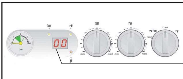
Les codes **E 1** puis **33** disparaissent et la température départ chaudière réapparaît.
