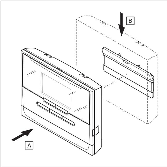
7. Hängen Sie den Regler gemäß der Abbildung in den Gerätehalter ein, bis er einrastet.
