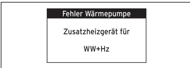
Wenn die Störungsmeldung auf dem Display erscheint, dann ist die Wärmepumpe ausgefallen und der Regler geht in den Notbetrieb. Das Zusatzheizgerät versorgt nun die Heizungsanlage mit Heizenergie. Der Fachhandwerker hat bei der Installation für den Notbetrieb die Temperatur gedrosselt. Sie spüren, dass das Warmwasser und die Heizung nicht sehr warm werden.
