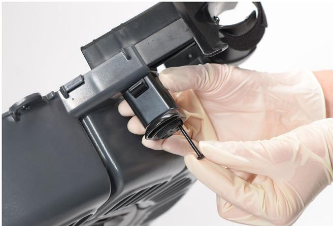
9. Fermer le boîtier et les six (6) verrous de boîtier en direction des roulettes pour verrouiller le boîtier du rM200.
