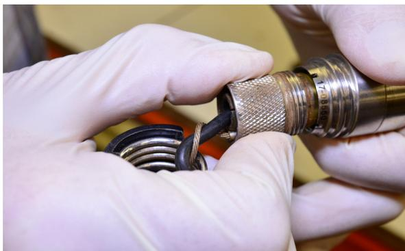
4. La sonde tourne lorsque vous enfiler la caméra sur le ressort. Faire tourner la caméra d'un tour dans le sens inverse des aiguilles d'une montre pour contrecarrer cette rotation et l'enfiler alors sur le ressort.
