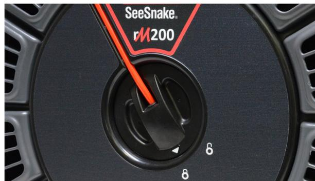
3. Accrocher le câble de système dans le crochet se trouvant sur le châssis et faire cliquer l'ancrage de câble sur le châssis.
