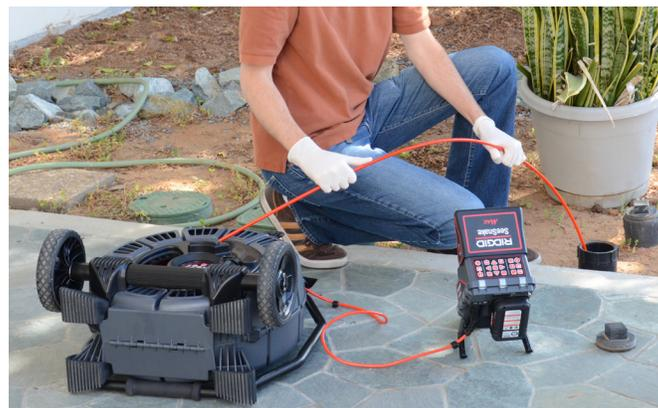
Mettre la poignée en position béquille lors d'une inspection sur un toit, sur une pente ou dans tous les endroits ayant une entrée en hauteur.
