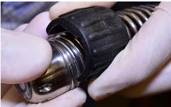
2. Aligner l'encoche se trouvant à l'intérieur de la clé avec l'extrémité de la spire du ressort.
