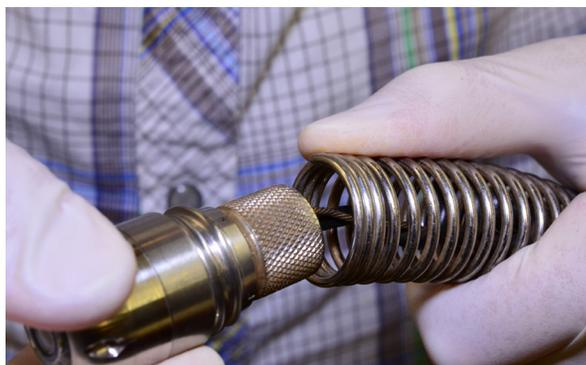
5. Enfiler le ressort sur la caméra jusqu'à ce que l'extrémité du ressort touche la tête de caméra.
