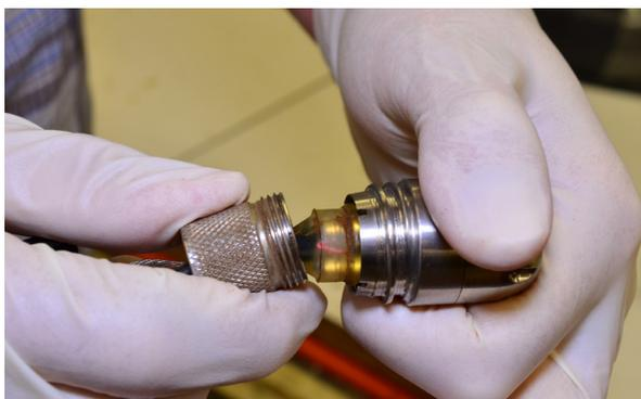
3. Pour assurer que les câbles de sécurité soient relativement droits lorsque vous vissez la caméra sur le ressort, faites-la tourner d'environ d'un tour et demi (dans le sens inverse des aiguilles d'une montre).
