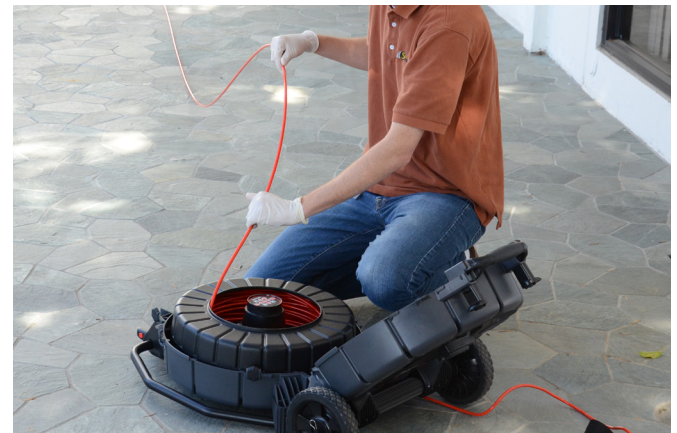
Abbildung 26 – Drehen der Trommel um das Schubkabel korrekt ab- und aufzuspulen
