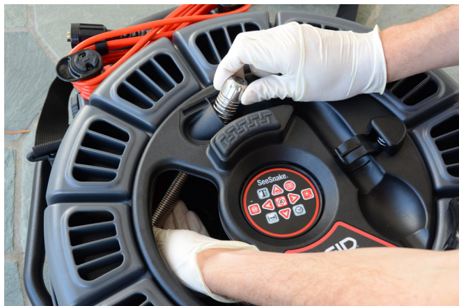
Abbildung 28 – Verlegung des Kamerakopfes
