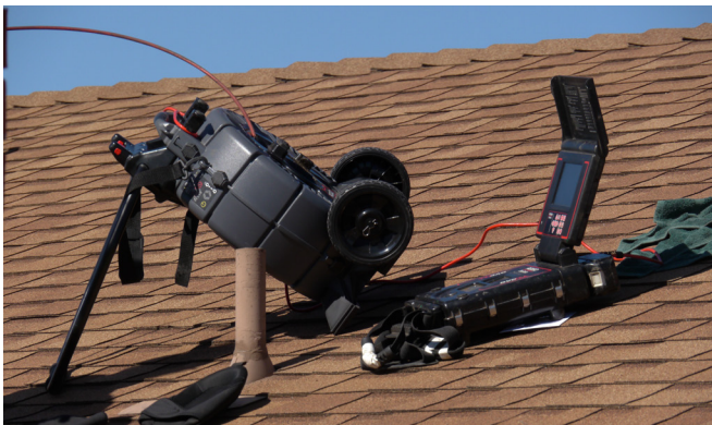
Abbildung 16 – Das rM200 und sein Ständer während einer Hausdachinspektion
