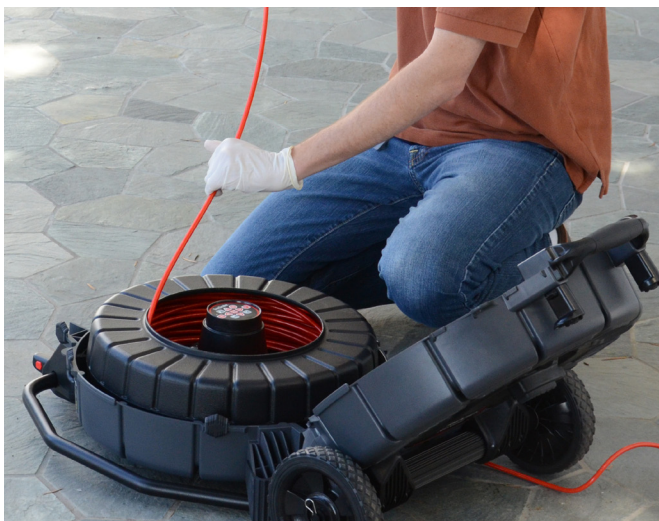
Abbildung 27 – Einführen des Schubkabels in die Trommel
