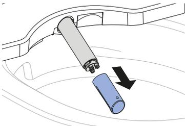
**4** Ersetzen Sie die Duschküse, falls sie sich nicht mehr vollständig reinigen und entkalken lässt.
