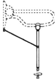
Bei Zweifeln über die Stabilität des Wandaufbaus, ist es empfehlenswert, diese Bodenstütze zur Montage der hochklappbaren Wandstützgriffe einzusetzen. Die Bodenstütze klappt durch ihre feste Verbindung mit dem Wandstützgriff ebenfalls hoch.
