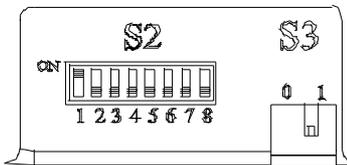
Microinterrupteurs à ajuster sur le circuit imprimé de l'appareil selon le nombre d'appareils branché - voir notices
