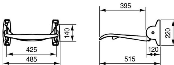
Un simple siège de douche qui offre une remarquable robustesse et sécurité lorsqu'il est correctement fixé au mur.
