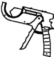
Pour une découpe perpendiculaire nette et sans bavures des tuyaux de chauffage de Ø 14 à 32 mm
