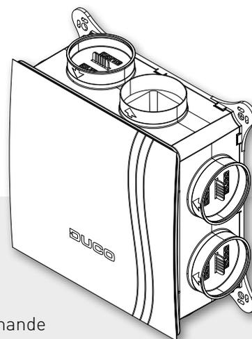
Le DucoBox Focus est une **unité d'aspiration** compacte, durable et extrêmement peu énergivore, **équipée d'un système de clapets de régulation** intégré fonctionnant sur la base de mesures de CO<sub>2</sub> et d'humidité, spécialement conçue pour une application dans des systèmes de ventilation naturelle à la demande de Duco, et évacue l'air humide et/ou vicié par zone, quand cela s'avère nécessaire et en quantité adaptée.
