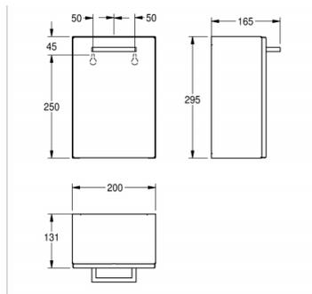
Hygieneabfallbehälter für Aufputzmontage, Chromnickelstahl, Oberfläche seidenmatt, Materialstärke 0,8 mm, gekantete Front, Fassungsvermögen zirka 3,7 Liter, integrierter Kunststoffbehälter zur Entnahme der Abfälle, inklusive Edelstahlstahlschrauben und Dübel.
