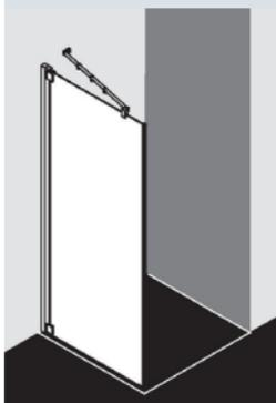
Teilgerahmte Seitenwand. Zur Kombination mit RA 1KR/L Pendeltür 1-flügelig / RA 1NR/L Pendeltür 1-flügelig mit Festfeld. Inklusive RAYA-Stabilisierung (innen). Verglasung mit 6 mm Einscheiben-Sicherheitsglas nach DIN EN 12150, optional mit Pflegeleicht-Beschichtung KermiCLEAN. Breite 900 mm, Höhe 2000 mm. Seitenwand links. Profile aus hochwertigem eloxiertem Aluminium, silber mattglanz. Beschläge aus hochwertigem Metall. Verstellmöglichkeit im Wandprofil 10 mm, im Beschlag 20 mm.
