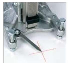
Effiziente Bohrständerausrichtung mittels serienmäßigen Zentrumszeigers
