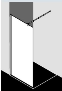
Walk-In Wall paroi en verre partiellement cadrée, avec fixation murale. Avec stabilisateur 90°. Verre de sécurité uni-couche 8 mm suivant DIN EN 12150 avec traitement KermiClean. Largeur 1600 mm, hauteur 2000 mm. Profilés en aluminium anodisé de haute qualité en argent brillant. Stabilisateur en aluminium anodisé et métal de haute qualité. Le profilé mural permet un ajustage de 20 mm.
