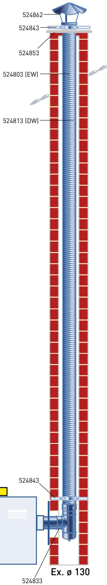
**Les flexibles d'évacuation des gaz de combustion en acier inoxydable doivent répondre aux normes européennes. Celles-ci déterminent la mesure dans laquelle le matériau d'évacuation des gaz de combustion est adapté à tel combustible et à tel type d'appareil, avec ou sans formation de condensation.**
