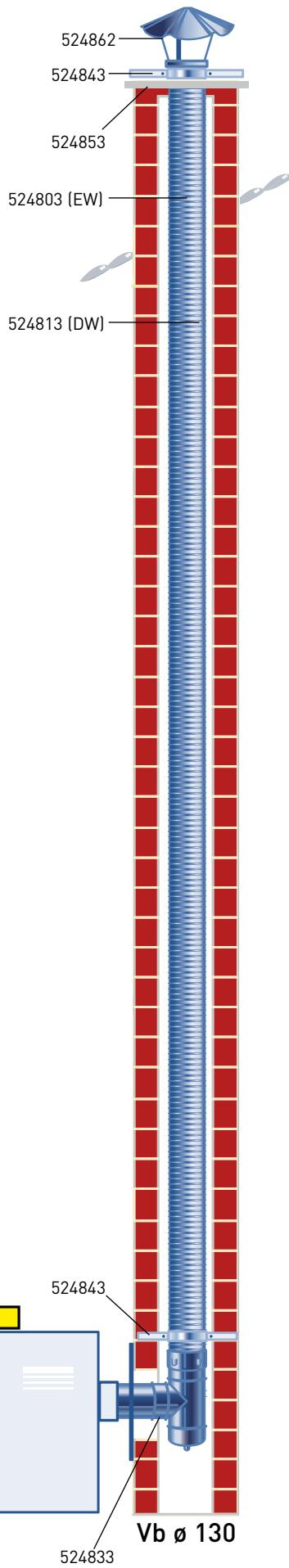
De flexibele rookgasafvoerkanaLEN in roestvast staal, dienen te voldoen aan de Europese normering.
